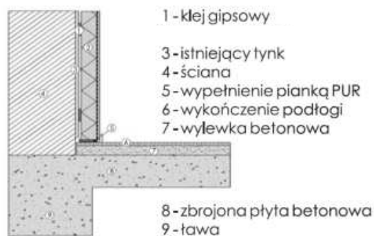
Rys. nr 7 schemat wykończenia płyt na styku ściana-posadzka
